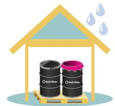
**Pour le stockage en fût**, celui-ci doit impérativement être certifié UN, muni d'une sache, de son couvercle et de son cerclage et être posé sur une palette solide.
