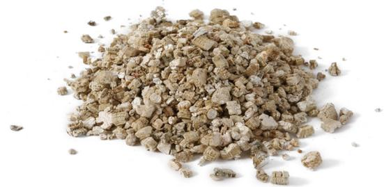
En effet, la vermiculite dans les contenants de stockage permet de limiter la propagation des échauffements à l'ensemble du contenant.
