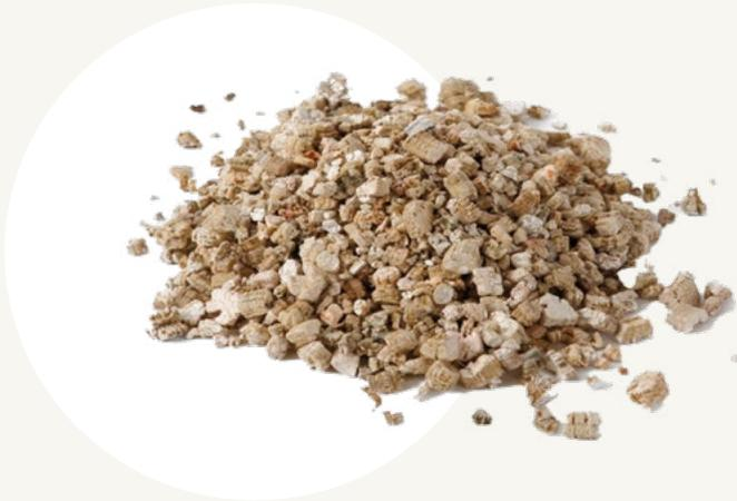
En effet, la vermiculite dans les contenants de stockage permet de limiter la propagation des échauffements à l'ensemble du contenant.
