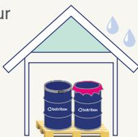
**Un extincteur à poudre** pour feux de lithium ou à défaut à CO<sub>2</sub> est recommandé à proximité du stockage des piles et batteries.
